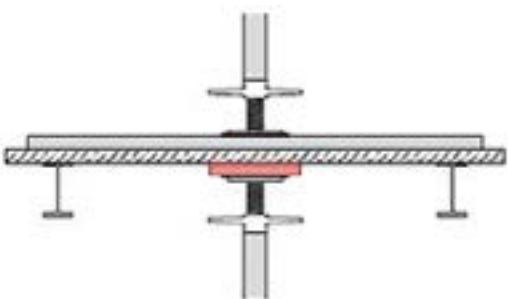
Figuur 21: doorstempeling vermijden
